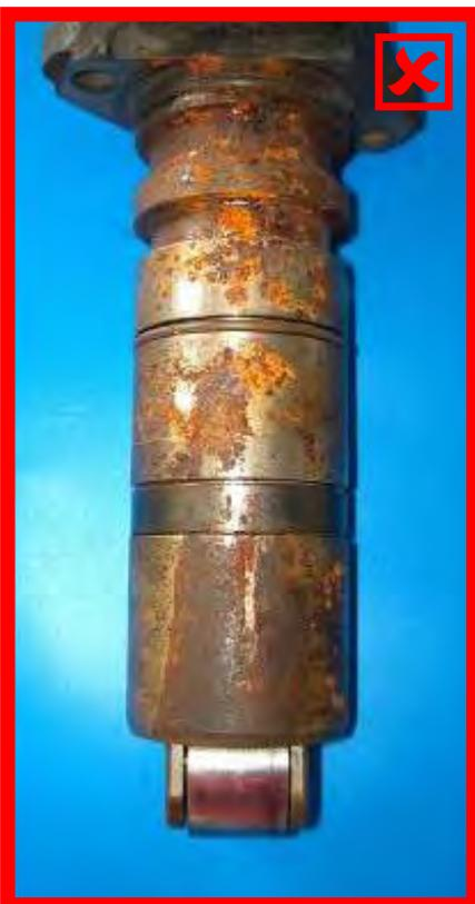
Povrchová koroze s úbytkem materiálu
