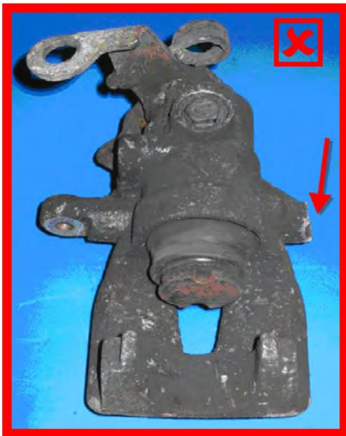
Poškození tělesa/krytu. Částečně ulomeno
