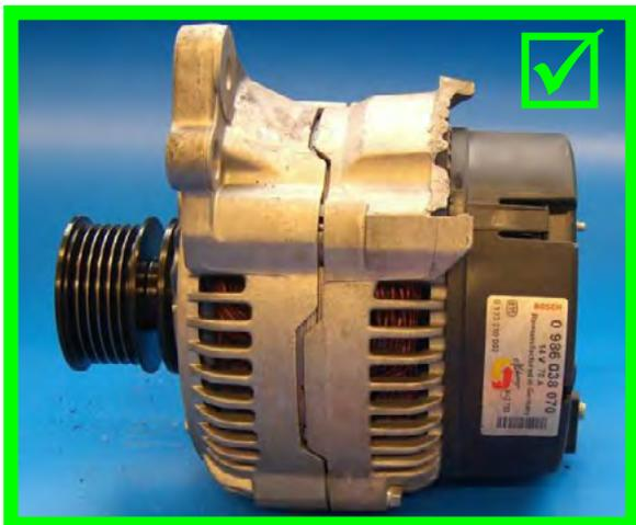
Těleso (upevňovací rameno)
