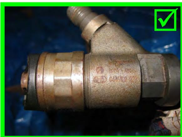
Těleso a upevnění elektromagnetu
