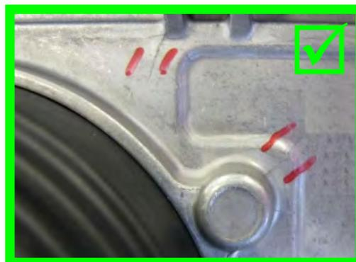
Výstupky na tělese po lití (žádné trhliny)
