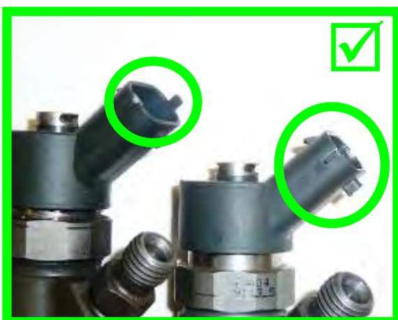
Chybějící výstupky → vyhovující
