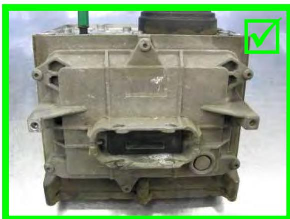
Slabá korozí na hliníkových dílech
