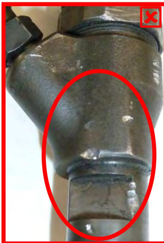
Poškození tělesa hlubokými škrábanci → nevyhovující
