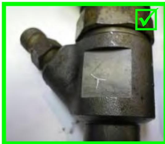
Poškození strojním značením/gravírováním/ražením/
