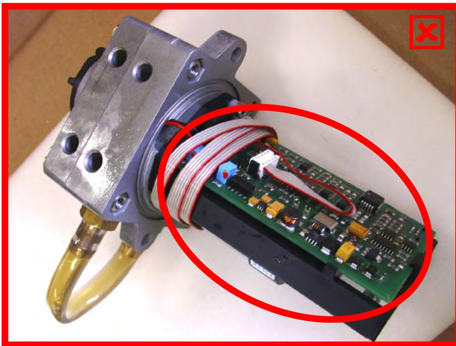
Tester s otevřenými deskami plošných spojů nebo bez ochrany proti elektrostatickému náboji (ESD) → nevyhovující
