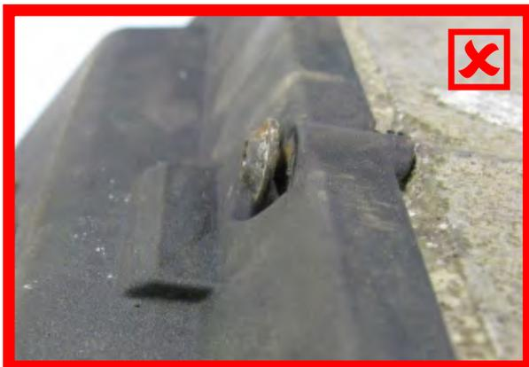
Modul byl otevřen/šrouby jsou uvolněné/šrouby chybí
