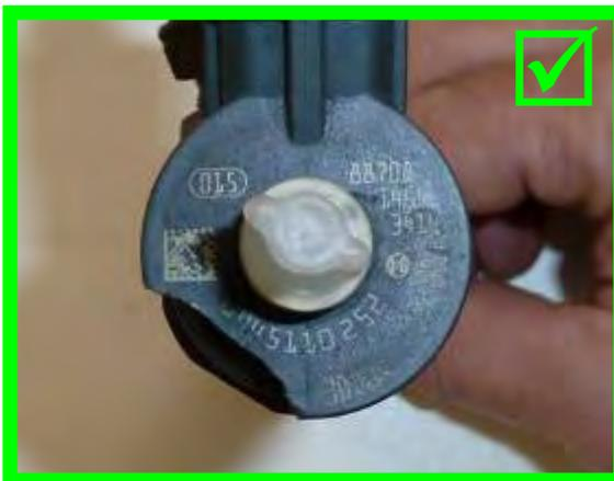
Poškození konektoru → vyhovující
