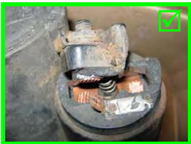
Poškození plastového dílu zasouvacího relé je povoleno, pokud není poškozeno těleso relé a zvláště jeho lem
