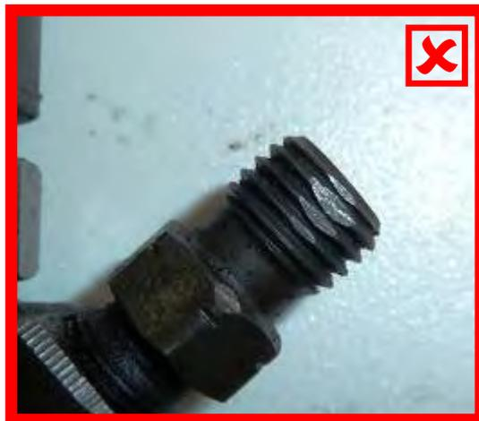
Poškození závitu → nevyhovující
