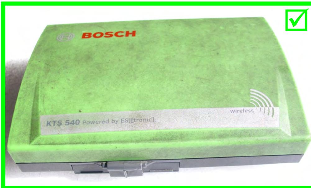
kryt znečištěn, povrch poškrábán → vyhovující
