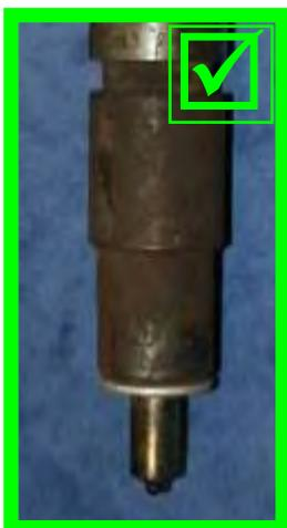
Koroze na celém těle → vyhovující
