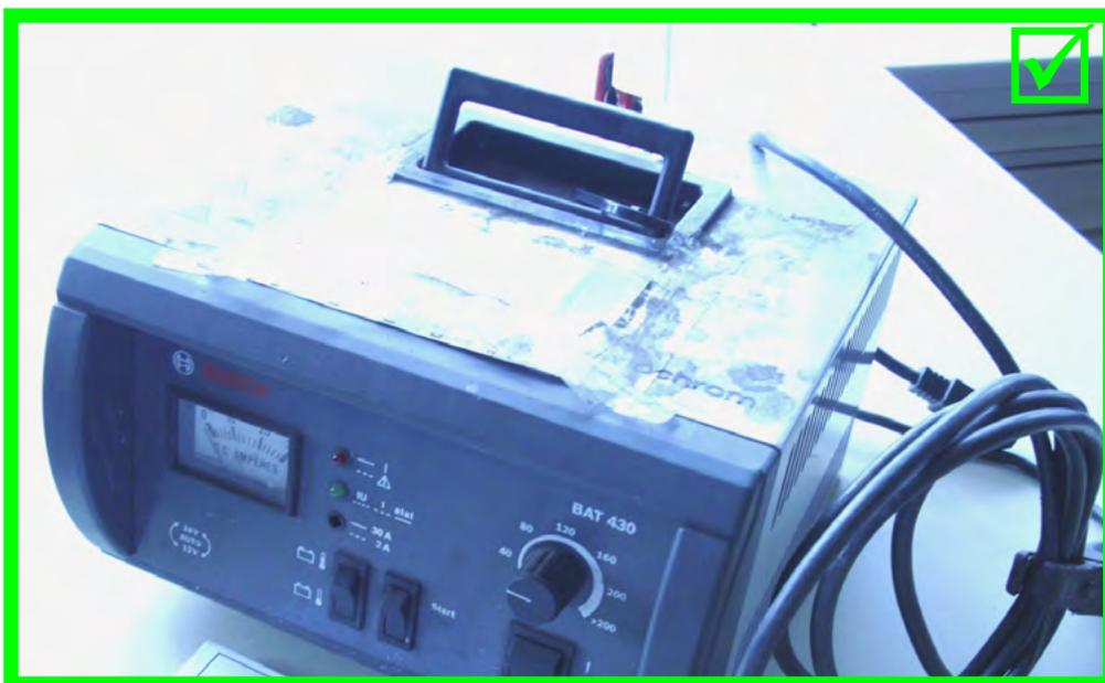
kryt znečištěn, polepen nálepkami → vyhovující
