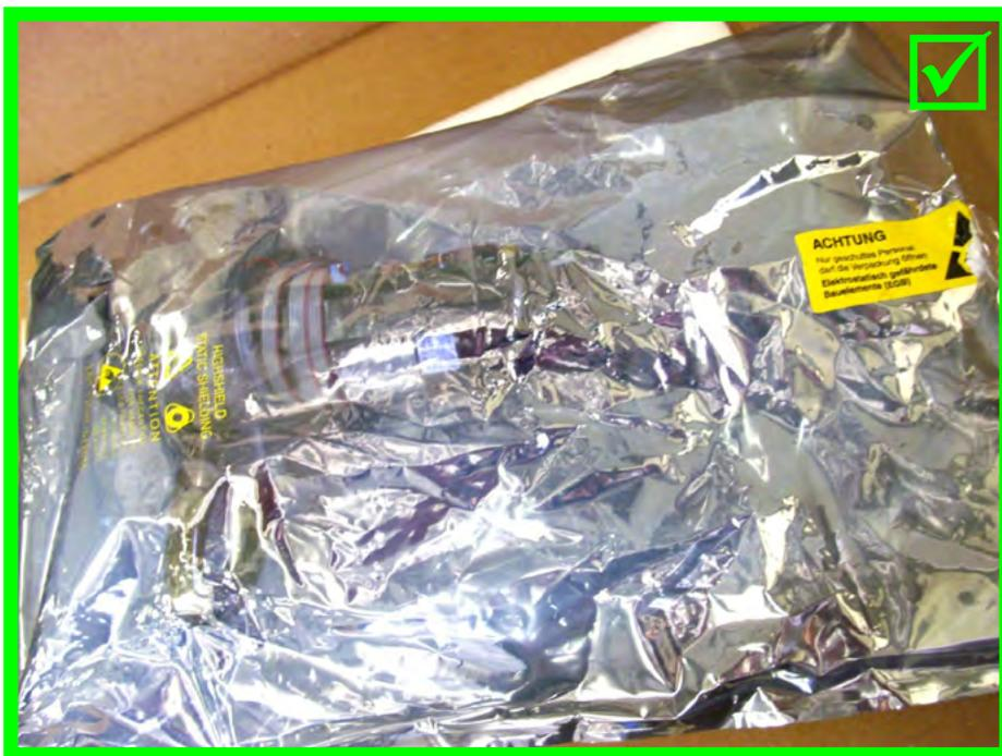
Tester s otevřenými deskami plošných spojů v ochranném obalu → vyhovující
