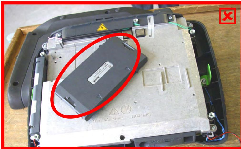
Tester bez krytu, otevřený kryt → nevyhovující
