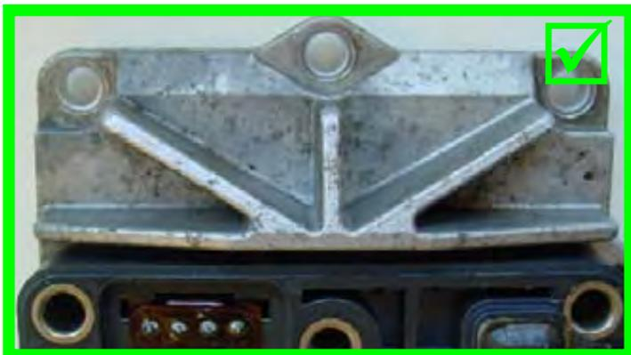
Lehká koroze hliníkového povrchu
