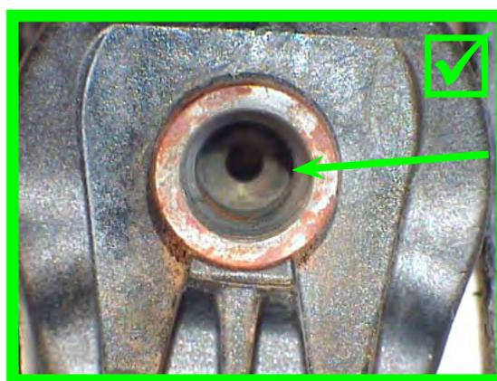
Zpětné vedení se silnou vnější korozí, malá koroze na vnitřním těsnicím povrchu
